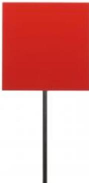
Le corps de résistance carré percé est étudié dans la section de mesure de la soufflerie HM 170. Le corps de résistance se compose d'un carré percé en tôle d'acier et d'une barre de maintien en acier inoxydable.
