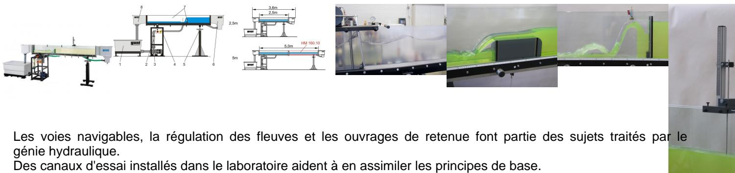
Les voies navigables, la régulation des fleuves et les ouvrages de retenue font partie des sujets traités par le génie hydraulique.
