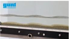
Les vannes planes font partie des ouvrages de contrôle mobiles; l'écoulement les traverse par dessous. Une vanne plane est une paroi verticale qui produit une retenue dans un canal traversé par un écoulement.
