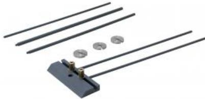
Les jetées ou les plateformes de forage sont en général construites sur des pilotis situés dans l'eau. L'eau en écoulement exerce des forces sur la partie des pilotis se trouvant sous la surface de l'eau, ce qui peut provoquer des oscillations.
