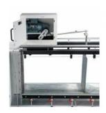
Les ondes de surface sont générées par une plaque de refoulement qui exécute un mouvement pivotant.
