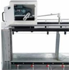
Les ondes de surface sont générées par une plaque de refoulement qui exécute un mouvement pivotant. La plaque est entraînée par un moteur avec convertisseur de fréquence par le biais d'un système bielle-manivelle.
