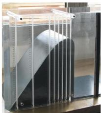
Les déversoirs à crête arrondie sont des déversoirs fixes qui font partie des ouvrages de contrôle.
