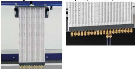
Pour de nombreux essais sur l'écoulement dans des canaux, il est important de connaître la profondeur de l'écoulement.
