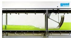
Les vannes radiales font partie des ouvrages de contrôle mobiles; l'écoulement les traverse par dessous. L'élément principal de la vanne radiale est une paroi ayant la forme d'un segment circulaire qui produit une retenue dans un canal traversé par un écoulement.
