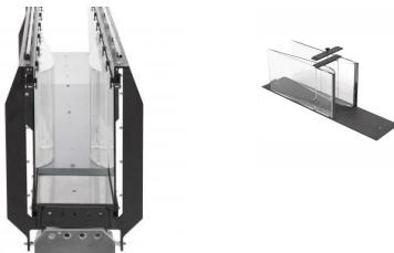
On détermine le débit d'un canal à l'aide de canaux jaugeurs.
