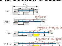
Le réservoir d'eau HM 162.20 est nécessaire en cas d'extension du canal dessai à une longueur de section dessai supérieure afin que la quantité d'eau disponible soit toujours suffisante.
