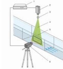
Un système PIV (Particle Image Velocimetry) permet de enregistrer des champs de vitesse dans la section dessai. L'accessoire HM 162.81 contient un système complet avec technique de nappe lumineuse, caméra et synchroniseur. Ce système est adapté aux mesures découlement bidimensionnelles.
