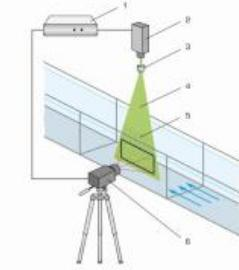
Un système PIV (Particle Image Velocimetry) permet de renregistrer des champs de vitesse dans la section dessai. L'accessoire HM 162.81 contient un système complet avec technique de nappe lumineuse, caméra et synchroniseur. Ce système est adapté aux mesures découlement bidimensionnelles.
