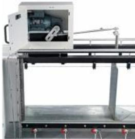
Les ondes de surface sont générées par une plaque de refoulement qui exécute un mouvement pivotant. La plaque est entraînée par un moteur avec convertisseur de fréquence par le biais d'un système bielle-manivelle.
