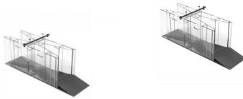
Les méthodes les plus couramment utilisées pour déterminer le débit dans un canal sont les canaux jaugeurs et les déversoirs de mesure.
