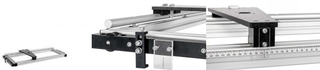
L'accessoire HM 161.59 est utilisé comme support pour instruments, par ex. pour le tube de Prandtl HM 161.50 ou la jauge à eau HM 161.52.
