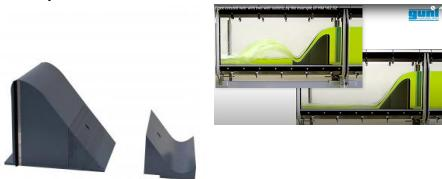
Les déversoirs à crête arrondie sont des déversoirs fixes qui font partie des ouvrages de contrôle. Lorsqu'un corps de déversoir est submergé, il se produit un changement d'écoulement: ce dernier devient supercritique.
