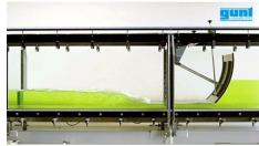
Les vannes radiales font partie des ouvrages de contrôle mobiles; l'écoulement les traverse par dessous.
