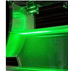
Un système PIV (Particle Image Velocimetry) permet d'enregistrer des champs de vitesse dans la section d'essai. L'accessoire HM 161.81 contient un système complet avec technique de nappe lumineuse, caméra et synchroniseur. Ce système est adapté aux mesures d'écoulement bidimensionnelles.
