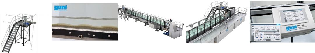
L'alimentateur en sédiments est constitué principalement d'une goulotte d'alimentation vibrante qui dépose les sédiments dans la section d'essai du HM 161.
