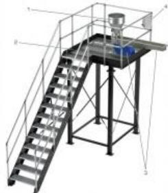
L'alimentateur en sédiments est constitué principalement d'une goulotte d'alimentation vibrante qui dépose les sédiments dans la section d'essai du HM 161.
