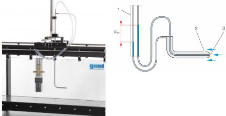
Le tube de Prandtl HM 161.50 est un dispositif de mesure de la vitesse d'écoulement dans le canal d'essai HM 161. Il mesure la pression statique et la pression totale au point souhaité de l'écoulement.
