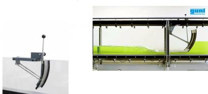
Les vannes radiales font partie des ouvrages de contrôle mobiles; l'écoulement les traverse par dessous.
