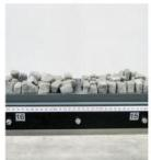
Le comportement d'écoulement d'une rivière dépend essentiellement, à débit égal, de la pente et de la rugosité du fond du canal.
