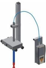
L'élément principal du tachymètre HM 160.64 est une roue à ailettes qui tourne sous l'effet de l'écoulement.
