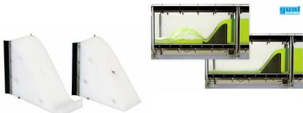
Les déversoirs à crête arrondie sont des déversoirs fixes qui font partie des ouvrages de contrôle.
