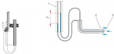
Le tube de Prandtl HM 160.50 est un dispositif de mesure de la vitesse découlement dans le canal dessai HM 160. Il mesure la pression statique et la pression totale au point souhaité de l'écoulement.
