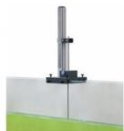
Pour de nombreux essais sur l'écoulement dans des canaux, il est important de connaître la profondeur de l'écoulement.
