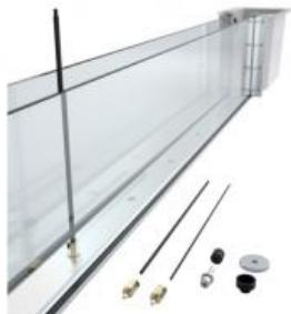
Les jetées ou les plateformes de forage sont en général construites sur des pilotis situés dans l'eau. L'eau en écoulement exerce des forces sur la partie des pilotis se trouvant sous la surface de l'eau, ce qui peut provoquer des oscillations.
