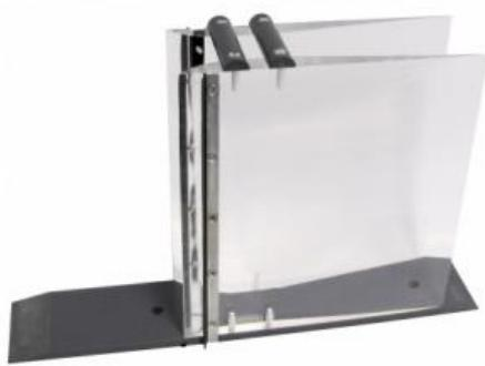
On détermine le débit d'un canal à l'aide de canaux jaugeurs.
