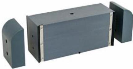
Ecoulement, nappe noyée, dénoyée sur un déversoir à seuil épais, influence des arêtes du déversoir
