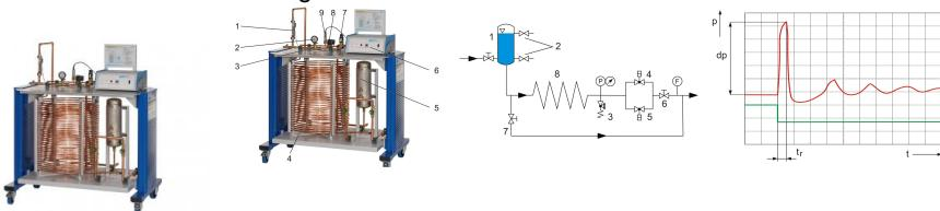
Les coups de bélier dans les tuyauteries posent de sérieux problèmes à tout système technique, car ils peuvent causer des dommages importants sur les tuyauteries, les robinetteries et les composants d'une installation.
