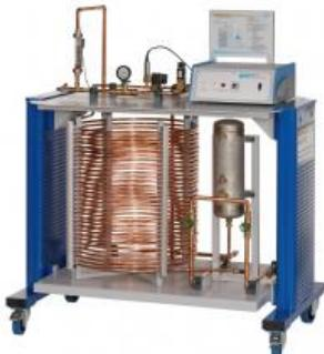
Les coups de bélier dans les tuyauteries posent de sérieux problèmes à tout système technique, car ils peuvent causer des dommages importants sur les tuyauteries, les robinetteries et les composants d'une installation.
