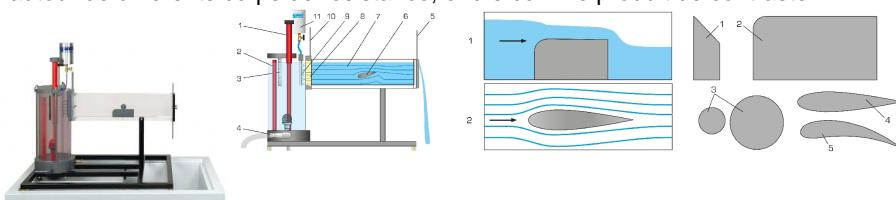
Le banc dessai HM 150.21 permet de visualiser les écoulements autour de corps de résistance et les phénomènes découlant dans des canaux ouverts.
