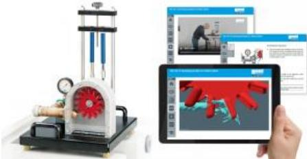
La turbine Pelton fait partie des turbines à jet libre qui transforment l'énergie de pression de l'eau, entièrement en énergie cinétique au sein du distributeur.
