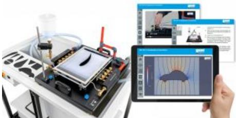
L'écoulement laminaire bidimensionnel de HM 150.10 donne une bonne approche de l'écoulement de fluides idéaux ou écoulement potentiel.
