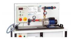
Les pompes centrifuges sont des turbomachines qui sont utilisées pour lacheminement de fluides.
