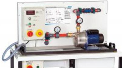
Les pompes centrifuges sont des turbomachines qui sont utilisées pour lacheminement de fluides. Le HM 150.04 permet détudier le fonctionnement dune pompe centrifuge et denregistrer une caractéristique typique de pompe.
