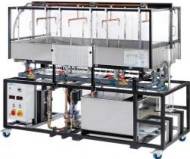
**HM 145 Études hydrologiques avancées, infiltrations, écoulements souterrains (Réf. 070.14500)**
