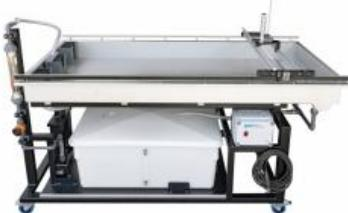
Avec HM 144, des phénomènes importants du transport par charriage dans la zone proche du lit sont montrés avec un écoulement sous-critique.
