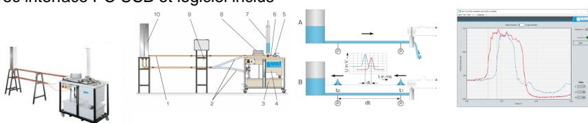
Dans les installations industrielles de type centrales hydro-électriques ou dans les systèmes d'alimentation en eau, les variations du débit entraînent des variations de la pression.
