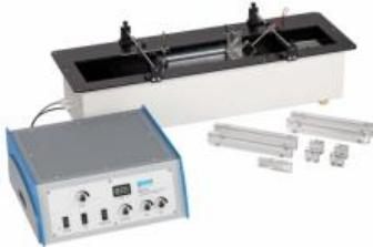
**Champs d'écoulement plan; visualisation via des bulles d'hydrogène générées par électrolyse**
