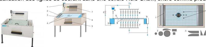
L'écoulement laminaire bidimensionnel de HM 152 donne une bonne approche de l'écoulement de fluides idéaux, ce que l'on appelle l'écoulement potentiel.
