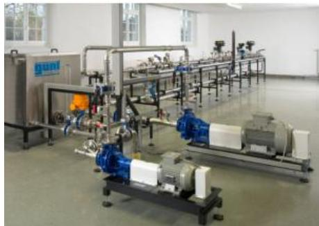
**HM 124 Installation d'essai de mécanique des fluides**
