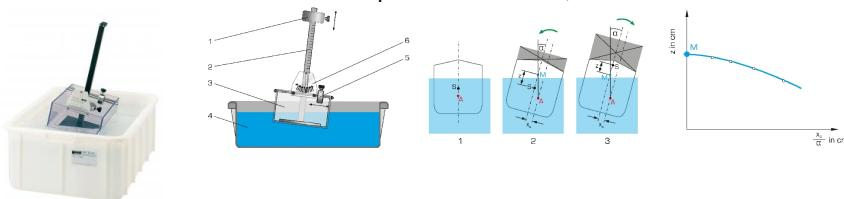
En hydrostatique, le métacentre est un point d'observation important pour évaluer la stabilité des corps flottants. La stabilité décrit la capacité d'un bateau à se redresser depuis une position gîtee.
