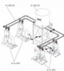
Le jeu d'accessoires comprend toutes les conduites, robinetteries et éléments de fixation nécessaires pour créer un montage expérimental complet pour réaliser des exercices de montage et de maintenance.
