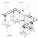
Le jeu d'accessoires comprend toutes les conduites, robinetteries et éléments de fixation nécessaires pour créer un montage expérimental complet pour réaliser des exercices de montage et de maintenance.
