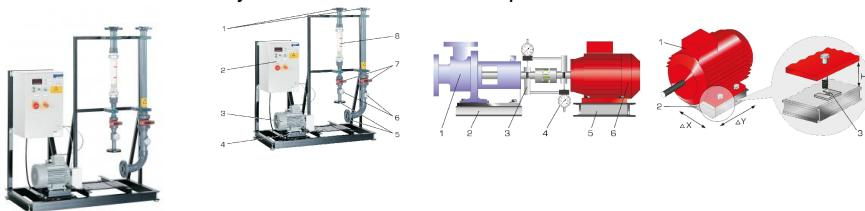
Voici les différentes étapes à suivre pour la réparation de machines réceptrices telles que les pompes: le démontage et montage des pompes en vue d'un contrôle, d'une réparation ou d'un remplacement; l'alignement de l'entraînement ainsi que la mise en service et le contrôle de la pompe, par ex. pour vérifier son étanchéité.
