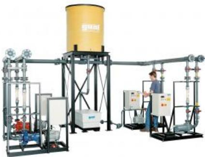
Les bancs de montage HL 962 sont reliés à l'aide d'éléments de tuyauterie HL 962.32 pour former une installation complexe de conduites et de pompes.
