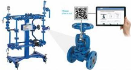
Le système HL 961 est un système compact de travaux pratiques et de formation servant d'introduction à la technique de montage industriel de tuyauterie et d'installations.
