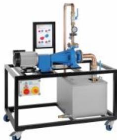
Une procédure de travail complète de réparation de machines réceptrices comme les pompes se compose des étapes de travail suivantes: montage - alignement - contrôle.
