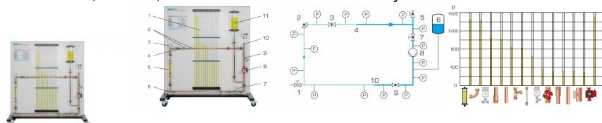
Lors de l'écoulement d'eau au travers d'un système de tuyauterie, des résistances apparaissent sous l'effet de changements de direction, de robinetteries et du frottement du tuyau.
