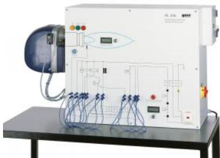
HL 356 démontre le mode de fonctionnement fondamental et le comportement typique d'un brûleur à gaz d'origine lors de perturbations de fonctionnement.
