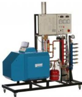
Le HL 353 pour la production d'eau chaude sert d'unité d'alimentation pour les bancs d'essai HL 353.01 et HL 353.02. Il est possible de monter une installation de chauffage complète en combinaison avec les HL 353.01 et/ou HL 353.02. Tous les composants sont usuels en technique de chauffage et offrent un rapport pratique élevé.
