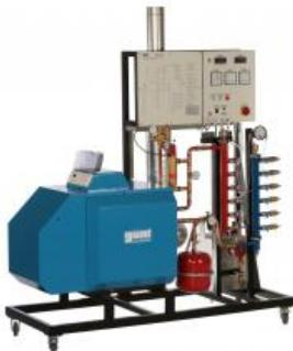
Le HL 353 pour la production d'eau chaude sert d'unité d'alimentation pour les bancs d'essai HL 353.01 et HL 353.02. Il est possible de monter une installation de chauffage complète en combinaison avec les HL 353.01 et/ou HL 353.02. Tous les composants sont usuels en technique de chauffage et offrent un rapport pratique élevé.
