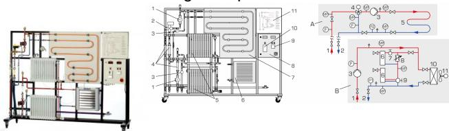
Le banc d'essai HL 353.01 permet le montage d'une installation de chauffage complète en combinaison avec un système de production d'eau chaude comme par exemple le HL 353.
