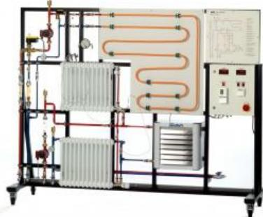
**HL 353.01 Installation chauffage domestique, planché chauffant, radiateurs, aérotherme (065.35301)**
