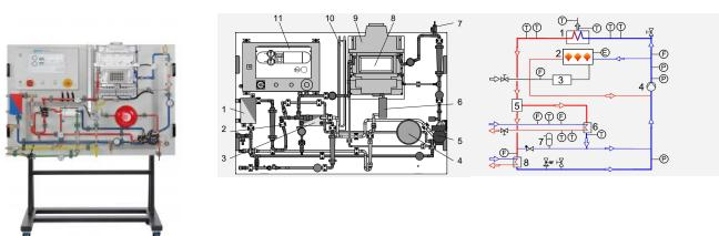
HL 530 illustre le fonctionnement d'une chaudière murale à double service (chauffage/eau chaude) à gaz.
