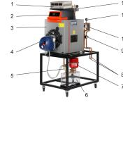
Le banc d'essai est équipé d'un brûleur à fioul.
