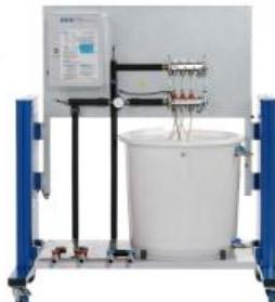
Les chauffages au sol transmettent la chaleur par l'intermédiaire de systèmes de canalisations en spirales ou en méandres situées en dessous du revêtement du sol.
