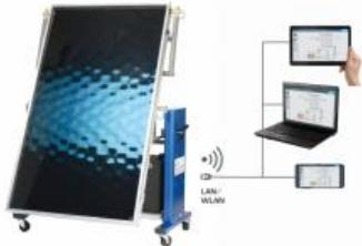
Le banc d'essai HL 313 permet de montrer les principaux aspects du réchauffement des eaux industrielles par héliothermie.
