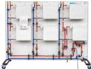
L'équilibrage hydraulique sert à limiter la quantité d'eau circulant dans le radiateur par rapport à celle calculée. Il doit garantir que tous les radiateurs puissent être alimentés en eau chaude en fonction de leur besoin à chaque point de fonctionnement.
