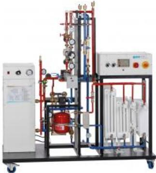
**HL 300 Chaudière électrique 15 kW avec installation de**
