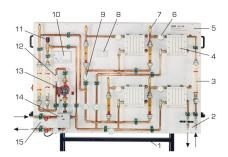
1 băți, 2 raccords d'eau froide, 3 rotamètre, 4 échangeur de chaleur à plaques, 5 panneau, 6 vanne thermostatique, 7 purge d'air, 8 capteur de température du local, 9 thermomètre bimétallique, 10 feuglateur de chauffage, 11 soupape de trop-plein, 12 capteur de température d'entrée circuit de chauffage, 13 pompe, 14 mélangeur, 15 raccords d'eau de chaudière
