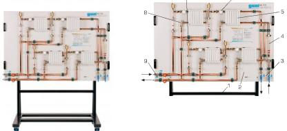
Le banc d'essai comprend un système de tuyauterie avec quatre radiateurs.
