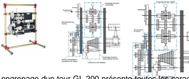
L'engrenage d'un tour GL 200 présente toutes les caractéristiques et propriétés essentielles d'un tour datelier: un engrenage principal commutable, un engrenage d'avance pour l'entraînement de la vis-mère (train baladeur Norton), un harnais d'engrenage à changement de vitesse et un renversement de marche.
