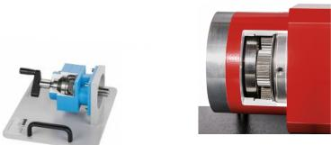
Ces modèles en coupe permettent d'expliquer de façon simple et précise le mode de fonctionnement des éléments constitutifs d'une machine, par exemple d'un embrayage à disques, de différents engrenages ou d'une chaise palier.
