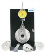
Les commandes à came font partie des engrenages à transmission irrégulière, qui sont utilisés pour transformer des mouvements entraînement circulaires réguliers, en mouvements entraînés irréguliers avec ou sans pause.
