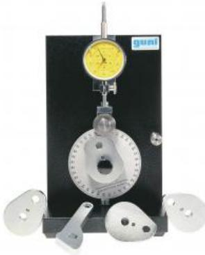
Les commandes à came font partie des engrenages à transmission irrégulière, qui sont utilisés pour transformer des mouvements entraînement circulaires réguliers, en mouvements entraînés irréguliers avec ou sans pause.
