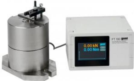
L'étude des efforts de coupe en perçage fait partie des essais fondamentaux dans le domaine de la technique dusinage par enlèvement de copeaux.
