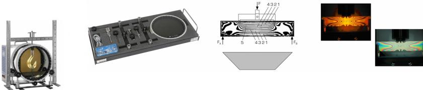
La photoélasticimétrie est une méthode éprouvée d'analyse et de enregistrement des contraintes mécaniques dans les composants.
